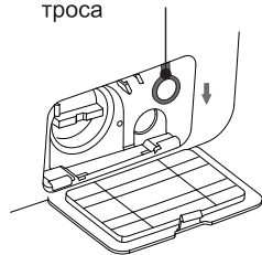
Аварийное натяжение троса
